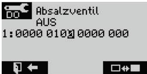
Die analogen Ausgänge können, wie bei den digitalen Ein- oder Ausgängen, mit den  $\uparrow/\downarrow$ -Tasten ausgewählt werden. Eine Manipulierung ist über die **Enter**-Taste möglich.
