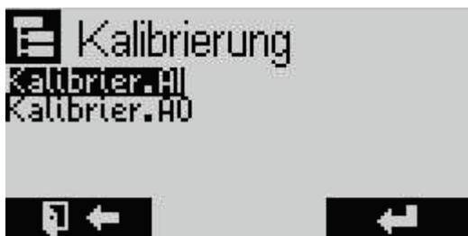
Nach Aufruf des Kalibriermenüs („Kalibrier. AI“) wird eine Übersichtsmaske aller analogen Eingänge dargestellt. Zur Anzeige kommt neben der Eingangsbezeichnung des aktuell ausgewählten Kanals (oberste Zeile), links der aktuelle Messwert („log.“) sowie rechts der Wandlerrohwert („phys.“).
